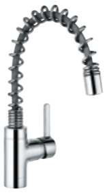
428550575 Drezová jednopáková batéria DN 10; s pružinou z ušľachtilej ocele, otočný, vyťahovací výtok H1 375, H2 220, A 215, Ø1 34, Ø2 48 Povrch: 05
