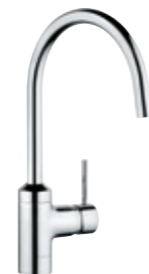
428030576 Drezová jednopáková batéria DN 10; otočný výtok H1 375, H2 230, A 215, Ø1 32, Ø2 48 Povrch: 05
