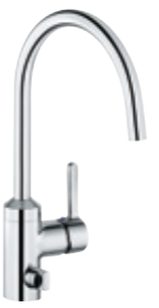
42836..75 Drezová jednopáková batéria s multiprípojku DN 10; otočný výtok, prípojka pre práčku a umývačku riadu H1 375, H2 230, A 215, Ø1 32, Ø2 48 Povrchy: 05, 96
